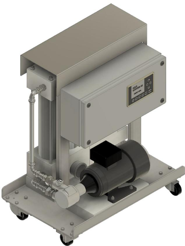
Das Umkehrosmosegerät **OSMO miro** besteht aus einem Edelstahlgehäuse, einer Hochdruckpumpe, den Umkehrosmosemodulen in Druckrohren sowie einer Mess- und Steuereinheit (SIEMENS) zur Steuerung und Überwachung der einzelnen Betriebszustände und einem integrierten Webserver zur Fernwartung. Eine automatische Permeatspülung, sowie eine Rezirkulation für eine hohe Ausbeute (WCF) gehören auch dazu.
